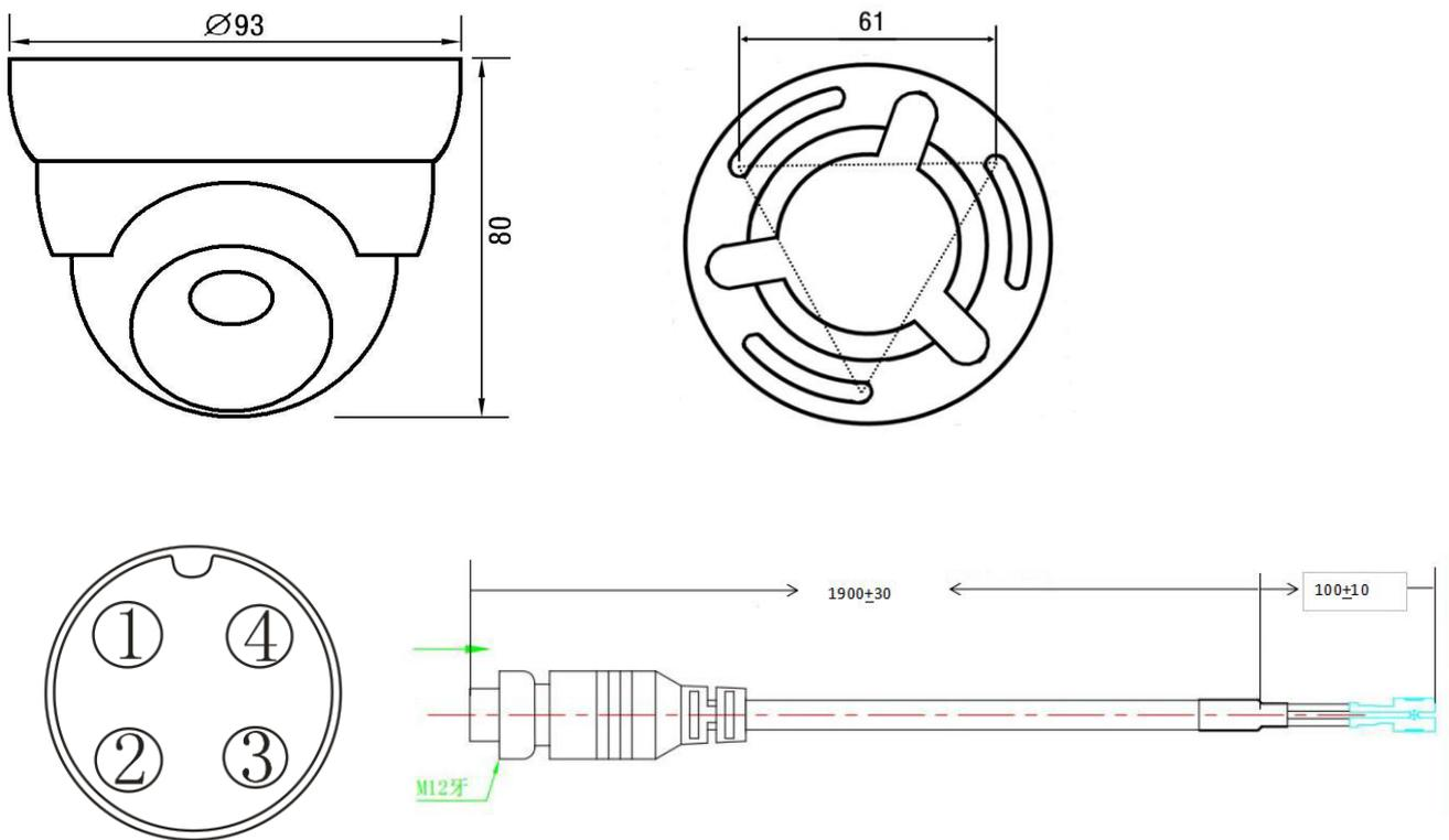
摄像机接线定义：1、电源正 2、电源负 3、空或音频 4、视频
